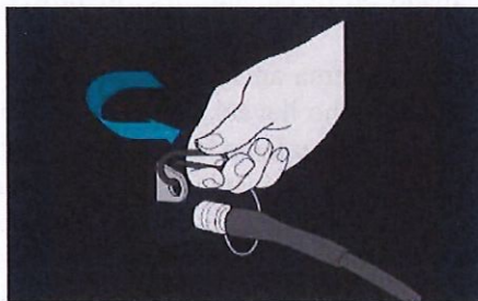
Figura 9. Fije el cable de seguridad a la consola
